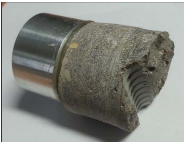
Obrázek č. 2: Fotodokumentace odtrhové zkoušky, vlevo odtržená panenka s tenkou vrstvou povrchové úpravy betonu, vpravo plocha po odtržení panenky
