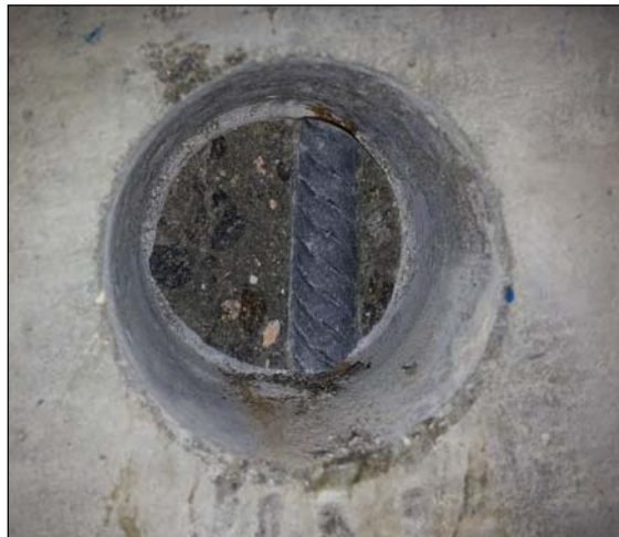
Obrázek č. 2: Fotodokumentace odtrhové zkoušky, vlevo odtržená panenka s tenkou vrstvou povrchové úpravy betonu, vpravo plocha po odtržení panenky
